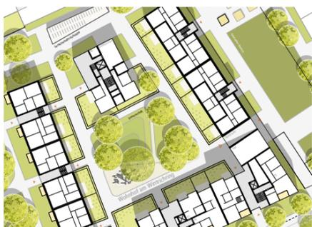
Detail 01 • Schallschutzbebauung • Grundriss EG
